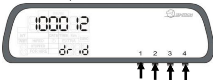
Taxametr vás vyzve k zadání Identifikace řidiče (pokud je naprogramováno), jinak nová směna začne automaticky.
