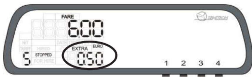
Během režimu „Jízdné“ stiskněte tlačítko 4 pro přidání příplatku. Příplatek bude zobrazen v displeji „Příplatek“. Kombinací tlačítek 3+4 příplatek smažete.
