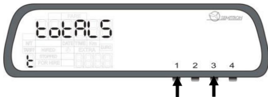
Stiskněte tlačítko 3 (celkem 12x), dokud se na displeji „Příplatek“ neobjeví číslice 12. Tlačítkem 1 můžete kdykoliv opustit pomocné menu.
