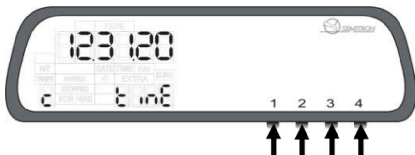
Hodnotu času zvýšíte tlačítkem 1 nebo hodnotu snížíte tlačítkem 2.
