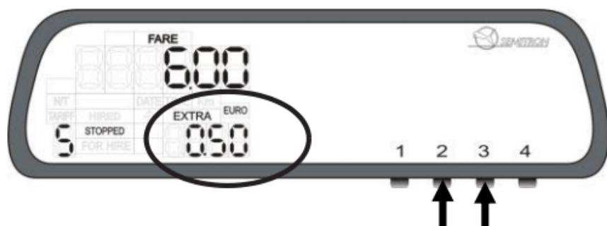
Pokud taxametr není nastaven pro automatické zobrazení součtu jízdného a příplatku, v režimu „Jízdné“ podržte tlačítko 3 a stiskněte tlačítko 2 pro zobrazení součtu.
